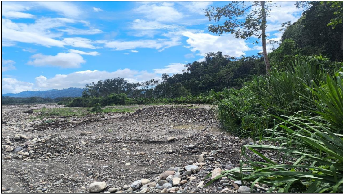
FIGURA N°01: PUNTO DE INICIO EN LA MARGEN DERECHA DE LA QUEBRADA CANAIRE (RIO CANAYRE) UBICADO EN SISTEMA DE COORDENADAS WGS 84 606515.00 E / 8639480 N, DONDE SE PUEDE EVIDENCIAR BASTANTE COLMATACIÓN DE MATERIAL DE RIO Y EROSIÓN DE RIBERA
